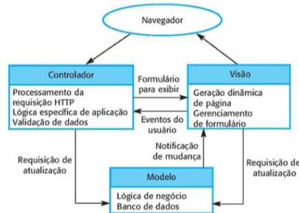
Figura 1. Arquitetura de padrão web usando o padrão MVC. Fonte: Sommerville (2018, p.156).
