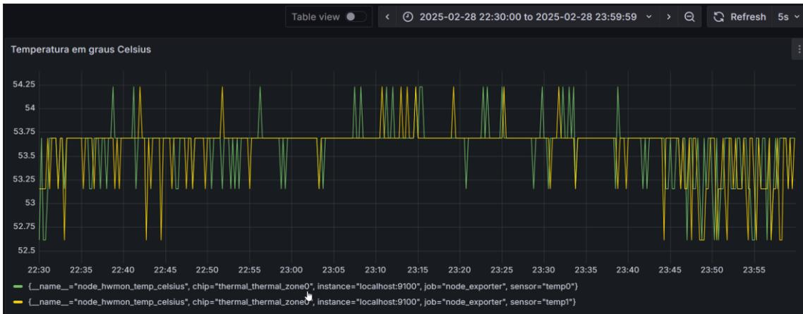
**Figura 12. Temperatura da Raspberry Pi em ociosidade.**
