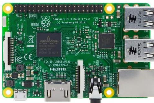
Figura 1. Raspberry Pi 3 Modelo B+. Fonte: Raspberrypi.com (2024)
