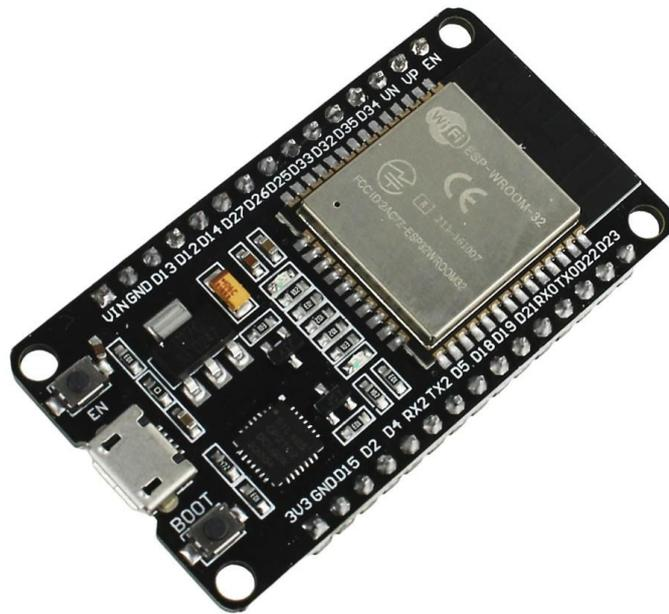
Figura 5. Imagem da placa de desenvolvimento ESP32 ESP-VROOM-32 com Wi-Fi e Bluetooth. Fonte: (MERCADO LIVRE, 2024).
