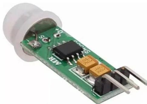
Figura 6. Imagem do sensor de movimento PIR HC-SR505. Fonte: (ELETROGATE, 2024).
